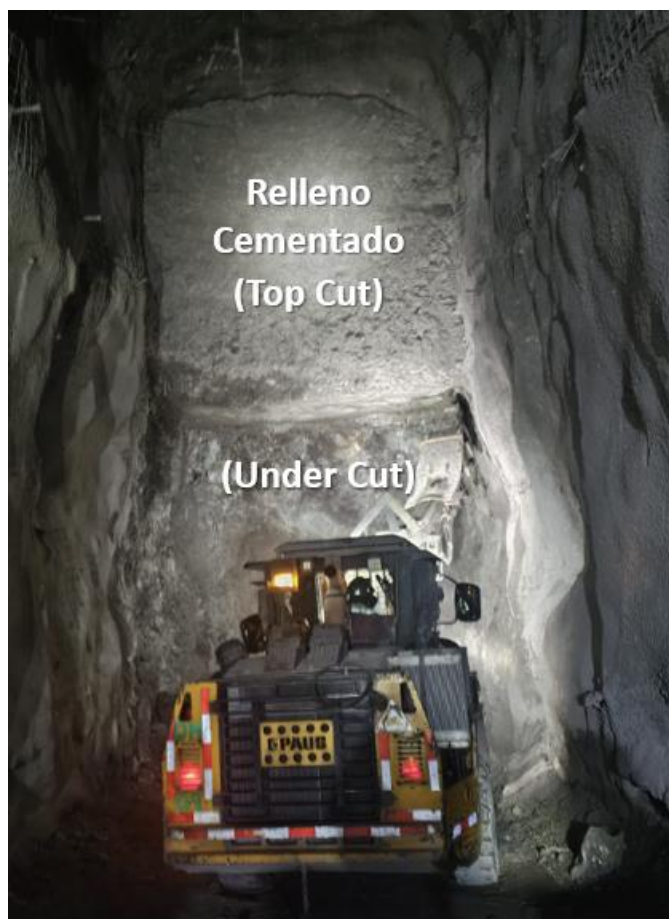
Figura N°28: Minado del Under Cut – Tajo Piloto Fuente: UM Tambomayo - Buenaventura
